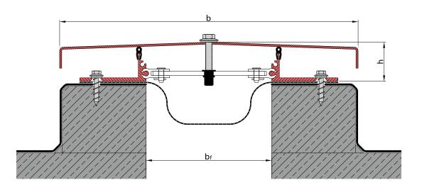
SEISMIC RESISTANT EXPANSION JOINT SOLLITIONS
