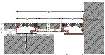
SEISMIC RESISTANT EXPANSION JOINT SOLUTIONS
