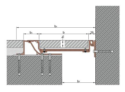
SEISMIC RESISTANT EXPANSION JOINT SOLUTIONS
