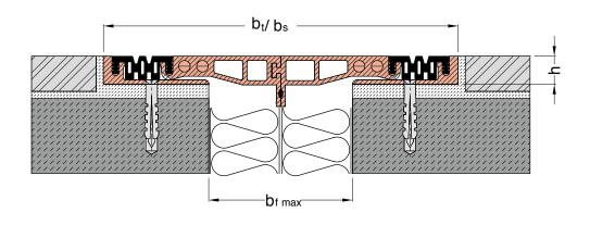
SEISMIC RESISTANT EXPANSION JOINT SOLUTIONS
