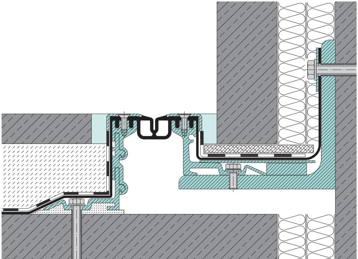
**Einbauvorschlag:** MIGUTAN-Fugenkonstruktion mit langen AAS-Folien als Wandanschluss in Sonderausführung
