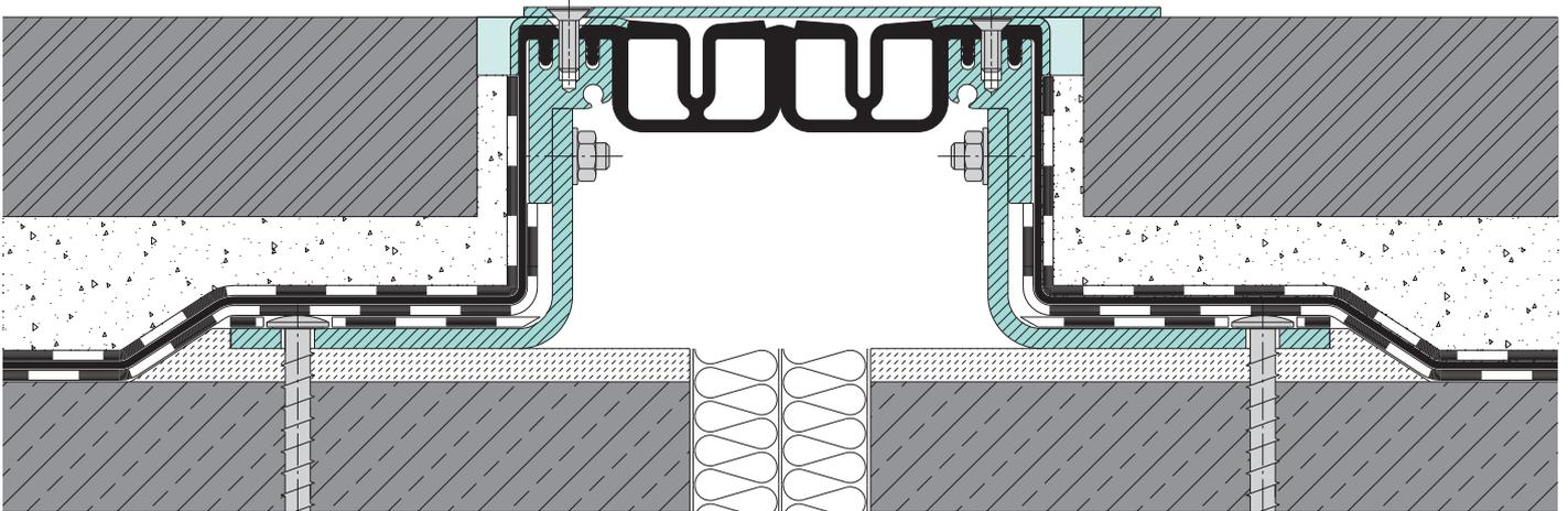
**Einbauvorschlag:** Profil FP 160/100 NI mit Abdeckplatte APG für breite Fugen und großer Bewegungsaufnahmen (105 mm + 65 mm / – 40 mm)
