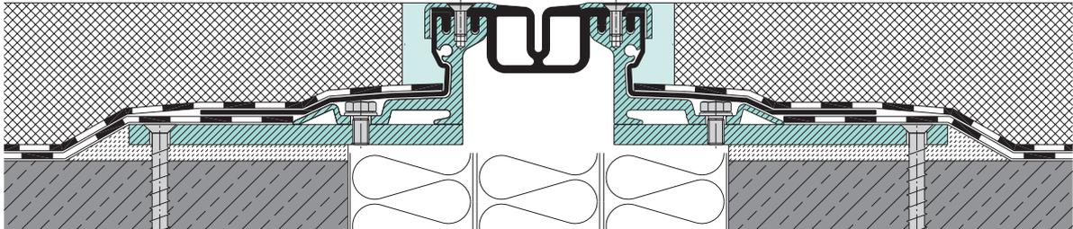
**Einbauvorschlag:** MIGUTAN-Fugenkonstruktion mit langen AAS-Folien und werkseitig angeschraubten Schleppblechen für extrem breite Bauwerksfugen
