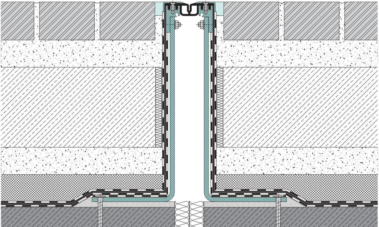
**Einbauvorschlag:** MIGUTAN-Fugenkonstruktion mit langen AAS-Folien für extrem große Konstruktionshöhen mit Druckverteilerplatte
