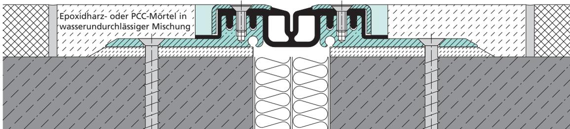
**FP 90/25 NI Einbauvorschlag:** MIGUTAN-Fugenkonstruktion mit kurzen AAS-Folien in Verbindung mit Hartstoffestrich oder Asphaltbelag ohne Flächenabdichtung
