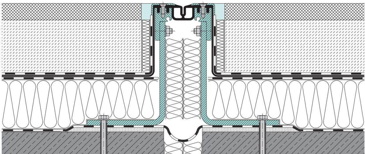
**Einbauvorschlag:** MIGUTAN-Fugenkonstruktion mit langen AAS-Folien in Verbindung mit gedämmten Aufbauten
