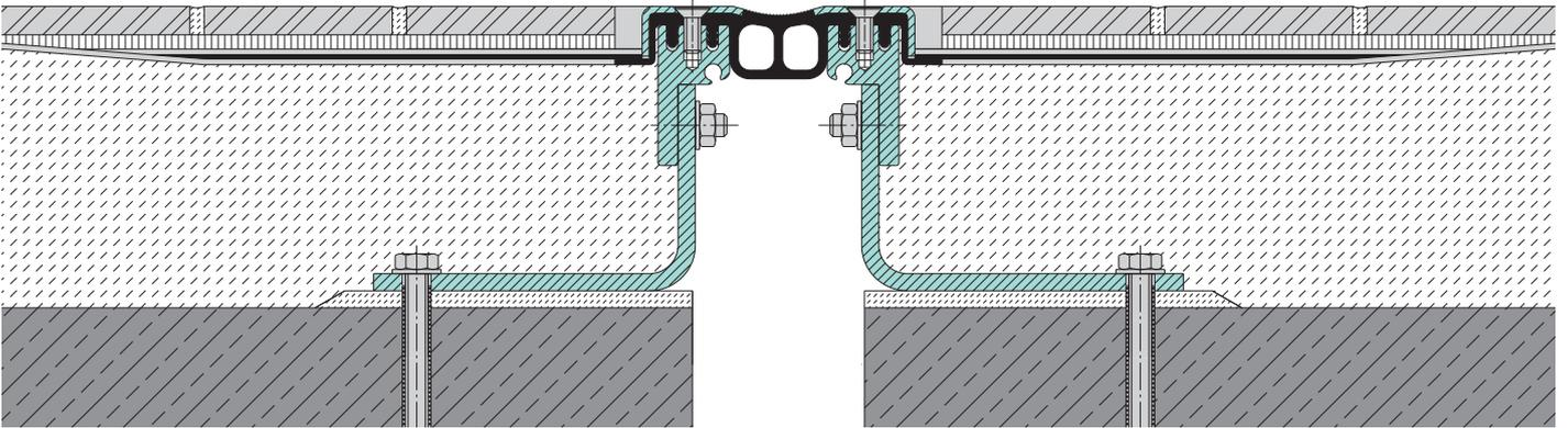
**Einbauvorschlag:** MIGUTAN-Fugenkonstruktion in Verbindung mit alternativer Abdichtung Profil FPG 90/100 NI XA mit MIGUTRIX-Folie (Montage auf Betondecke)
