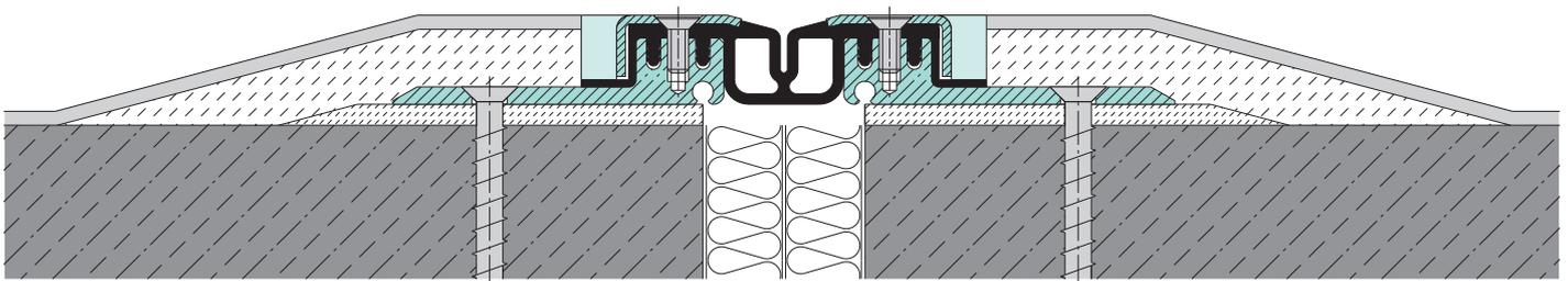
**FP 90/25 NI Einbauvorschlag:** MIGUTAN-Fugenkonstruktion mit kurzen AAS-Folien auf Rohbetondecke aufgesetzt
