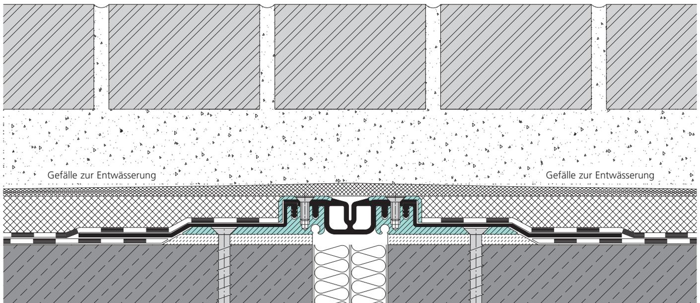
**Einbauvorschlag:** MIGUTAN-Fugenkonstruktion mit langen AAS-Folien überbaut eingesetzt
