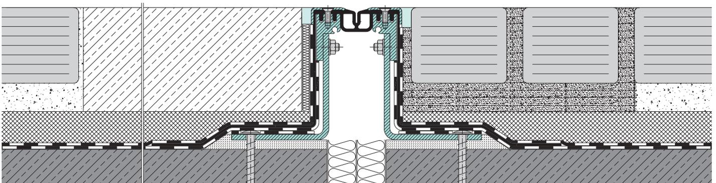
**Einbauvorschlag:** MIGUTAN-Fugenkonstruktion mit langen AAS-Folien für große Konstruktionshöhen
