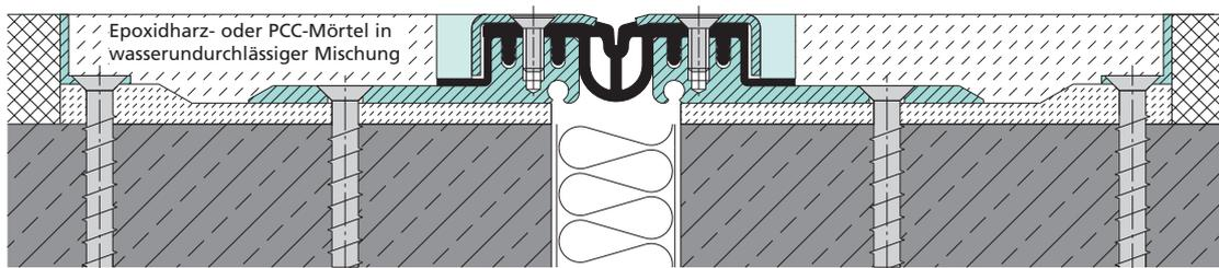
**FP 80/25 NI Einbauvorschlag:** MIGUTAN-Fugenkonstruktion mit kurzen AAS-Folien in Verbindung mit Hartstoffestrich oder Asphaltbelag ohne Flächenabdichtung
