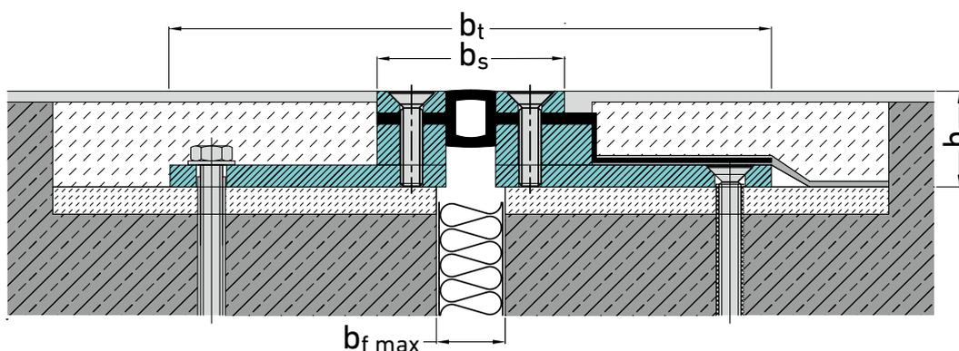
FPSG 68/35 ES avec bavette de raccordement. Étanchéité avec résine liquide (avec feuilles XA)
