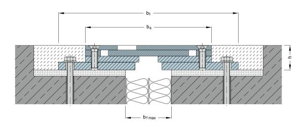
FOR HEAVY DUTY FLOORS WITH SMALLER INSTALLATION HEIGHTS
